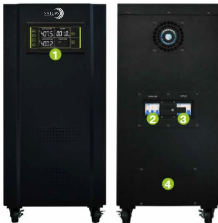
Figura 6 - Fronte e Retro SVCT 9 - SVCT 18 - SVCT 25 - SVCT 50 (1. Display, 2. Interruttore Stabilizzatore, 3. Interruttore Bypass, 4. Pannello di accesso alla Morsettiera)
